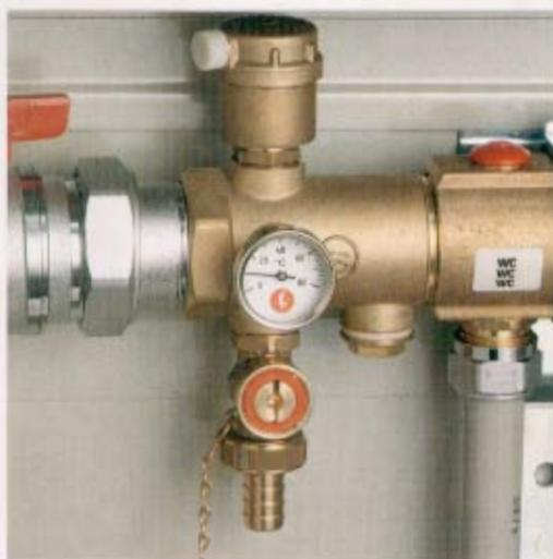
El record intermedio R554D tiene enlaces macho-hembra, y está completo con purgador automatico R88/1 de 1/2", grifo descarga R608 de 1/2", termometro R540 de 3/8", tapón R92 de 1/2" para eventuales enlaces de la sonda de relieve de la temperatura para el contador de calor hay un tapón R592 para instalar en la extremidad derecha o izquierda del colector.
